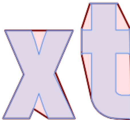
*Vereinfachung der Außenhülle eines MultiPolygons, mit Segmentierung*
