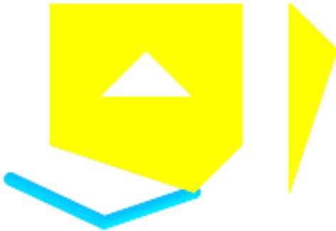
*Ein Mehrfachpolygon das an einem Linienzug gefangen wird; die Toleranz beträgt 1.01 der Entfernung. Das neue Mehrfachpolygon wird mit dem betreffenden Linienzug angezeigt.*
