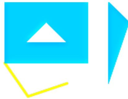
*Ein Linienzug der an dem ursprünglichen Mehrfachpolygon gefangen wird; die Toleranz beträgt 1.25 der Entfernung. Das neue Linienzug wird mit dem betreffenden Mehrfachpolygon angezeigt.*
