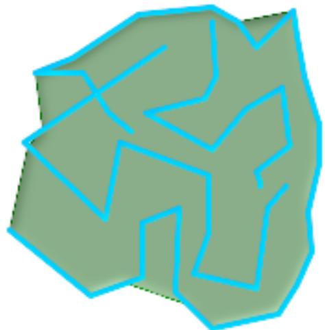
*MultiLineString überlagert mit der konkaven Hülle der LineStrings mit einem Zielwert von 99% - erster Versuch*
