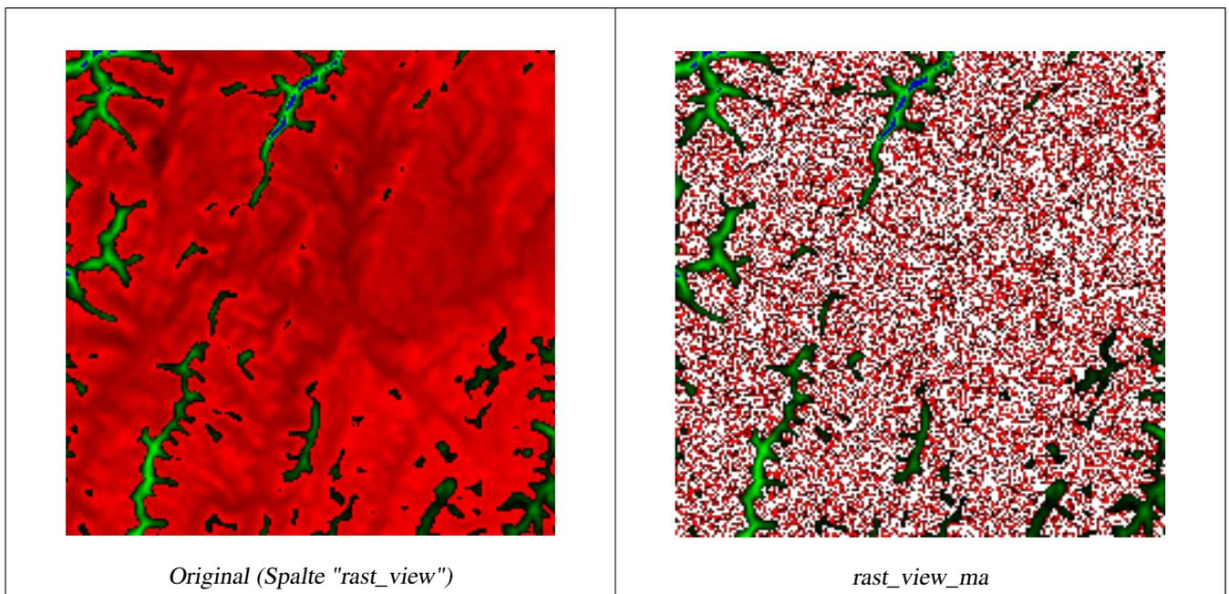
Erzeugt einen neuen Raster mit 3 Bändern und demselben Pixeltyp als unser ursprünglicher Raster mit 3 Bändern. Das erste Band wird über einen Map Algebra Ausdruck geändert, die verbleibenden 2 Bänder sind unverändert.
