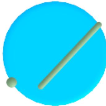
*Minimaler Umgebungskreis eines Punktes und eines Linienzuges. Verwendet 8 Segmente um einen Viertelkreis anzunähern.*
