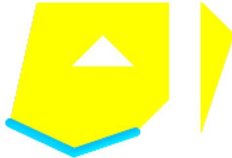
*Ein Mehrfachpolygon das an einem Linienzug gefangen wird; die Toleranz beträgt 1.25 der Entfernung. Das neue Mehrfachpolygon wird mit dem betreffenden Linienzug angezeigt.*
