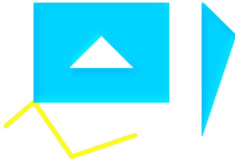
*Ein Linienzug der an dem ursprünglichen Mehrfachpolygon gefangen wird; die Toleranz beträgt 1.01 der Entfernung. Das neue Linienzug wird mit dem betreffenden Mehrfachpolygon angezeigt.*
