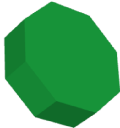
Ein Sechseck, das um 30 Einheiten entlang Z extrudiert wird, ergibt eine PolyhedralSurfaceZ
