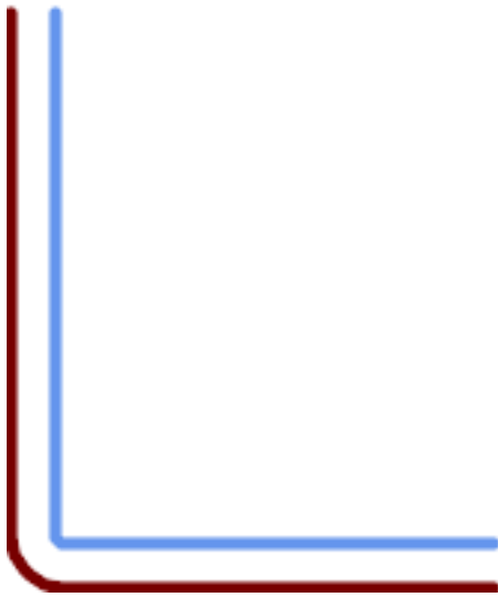
15, 'quad_segs=4 join=round' Ausgangslinie und die um 15 Einheiten versetzte Parallele.
