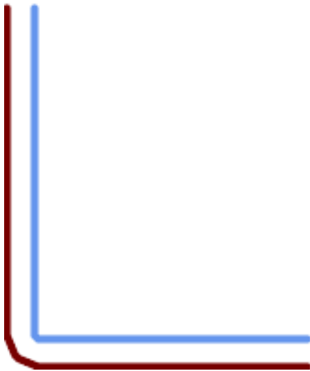
15, 'quad_segs=4 join=bevel' gemeinsam mit der Ausgangslinie
