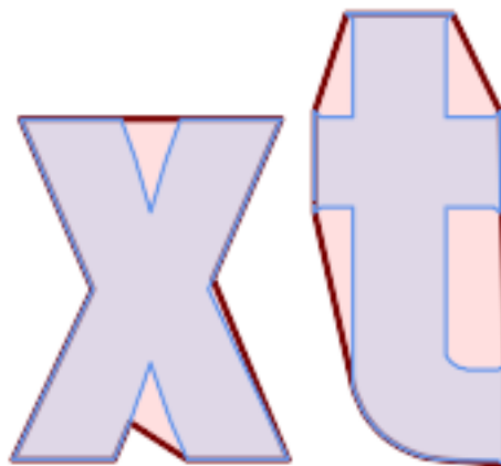
Vereinfachung der Außenhülle eines MultiPolygons, mit Segmentierung
