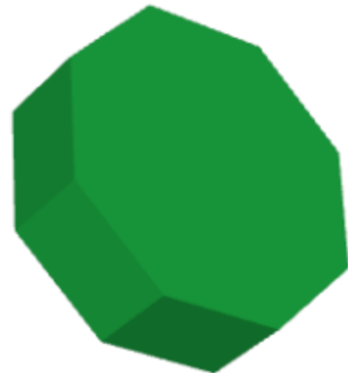
Z 方向に 30 単位押し出して得た PolyhedralSurfaceZ
