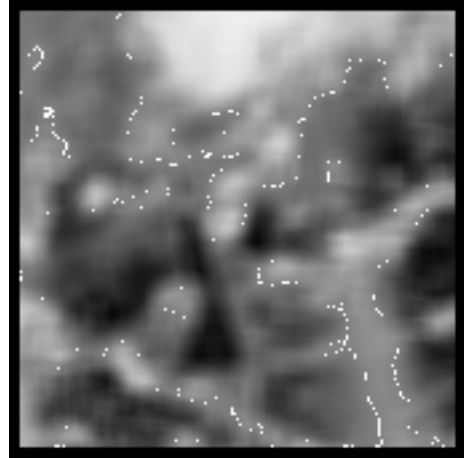
neuer Raster mit dem Durchschnittswert der Pixel innerhalb von 4x4 Pixel
