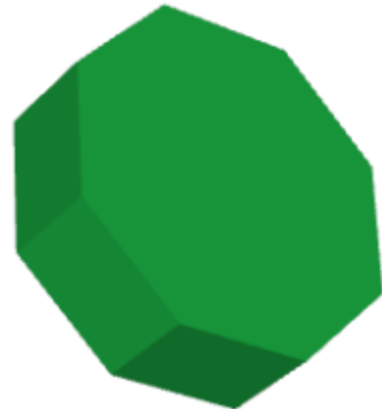
Ein Achteck, um 30 Einheiten entlang der Z Achse ausgeweitet, ergibt ein PolyhedralSurfaceZ
